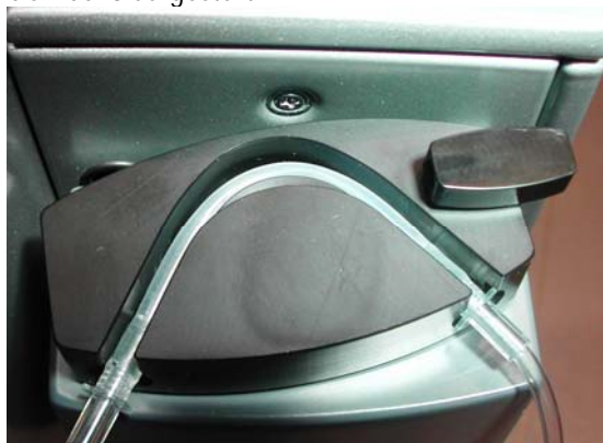
Abb. 3 Montage der Leitung um das Pumpenrad
