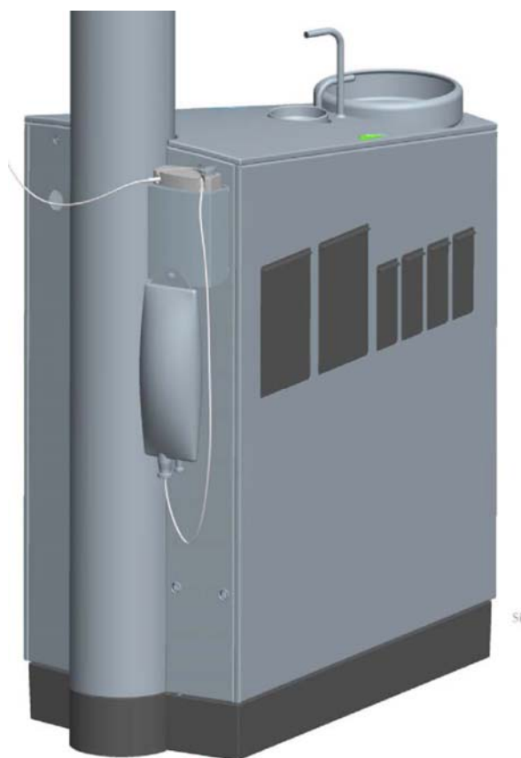
Abb. 4 Montage der Spülleitung mit Beutel
