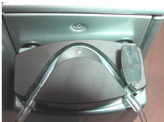
Abb. 3 Montage der Leitung um das Pumpenrad
