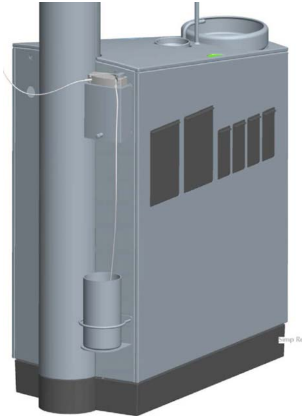
Abb. 5 Montage der Spüleleitung mit Flasche oder Becher
