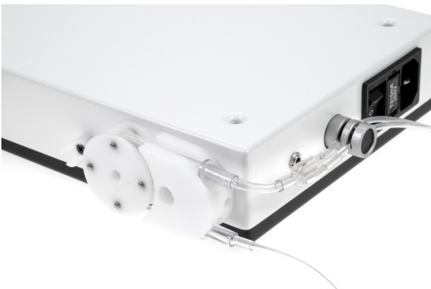
Abbildung 8 Legen Sie die beiden Schläuche in das Klemmventil.
